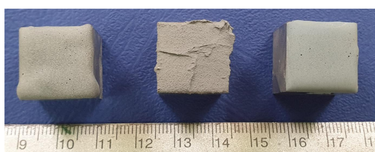
Slika 2. Uzorci nakon ispitivanja otpornosti na erozijsko trošenje premaza
