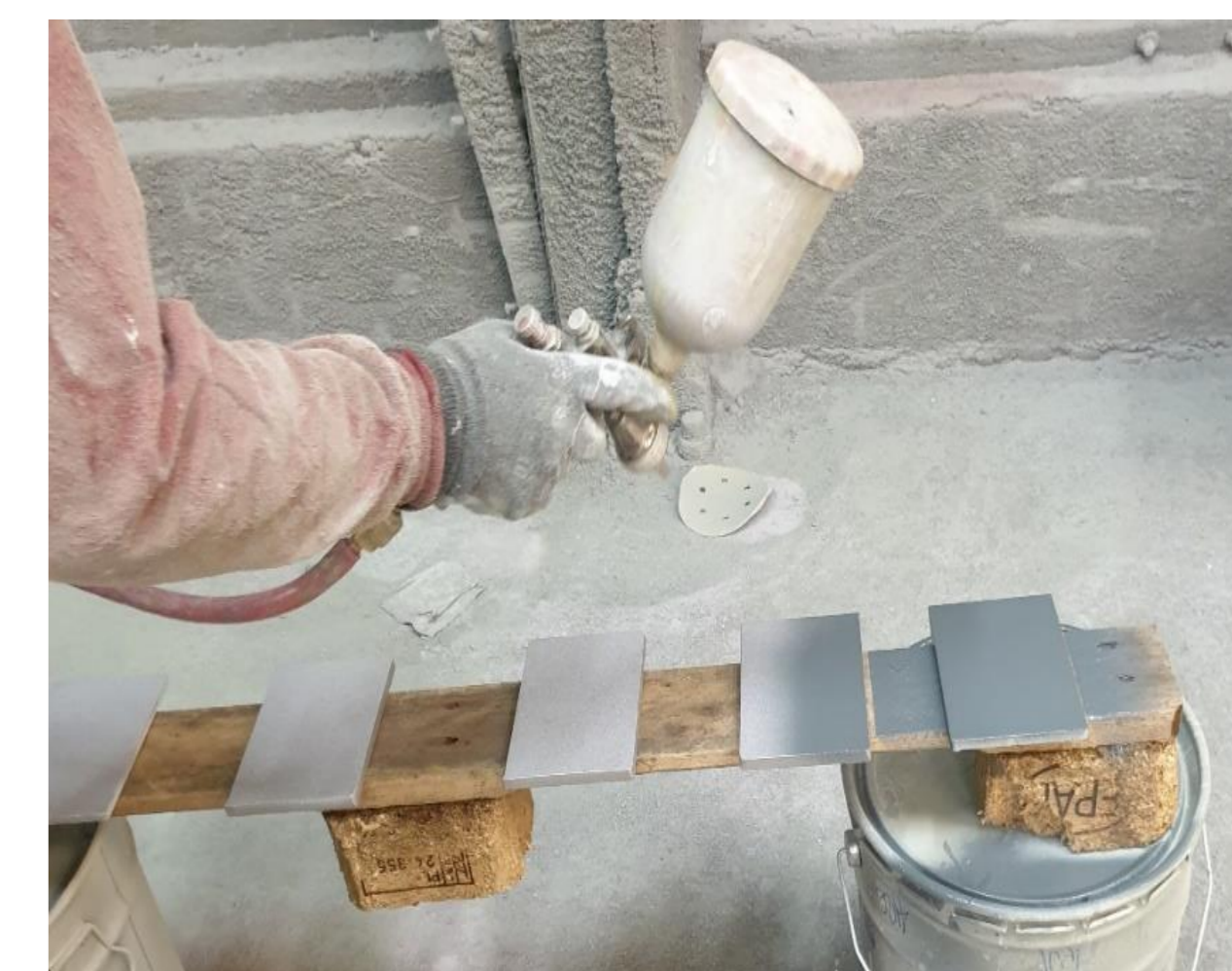
Slika 4. Nanošenje premaza na ispitne uzorke metodom prskanja zračnim pištoljem
