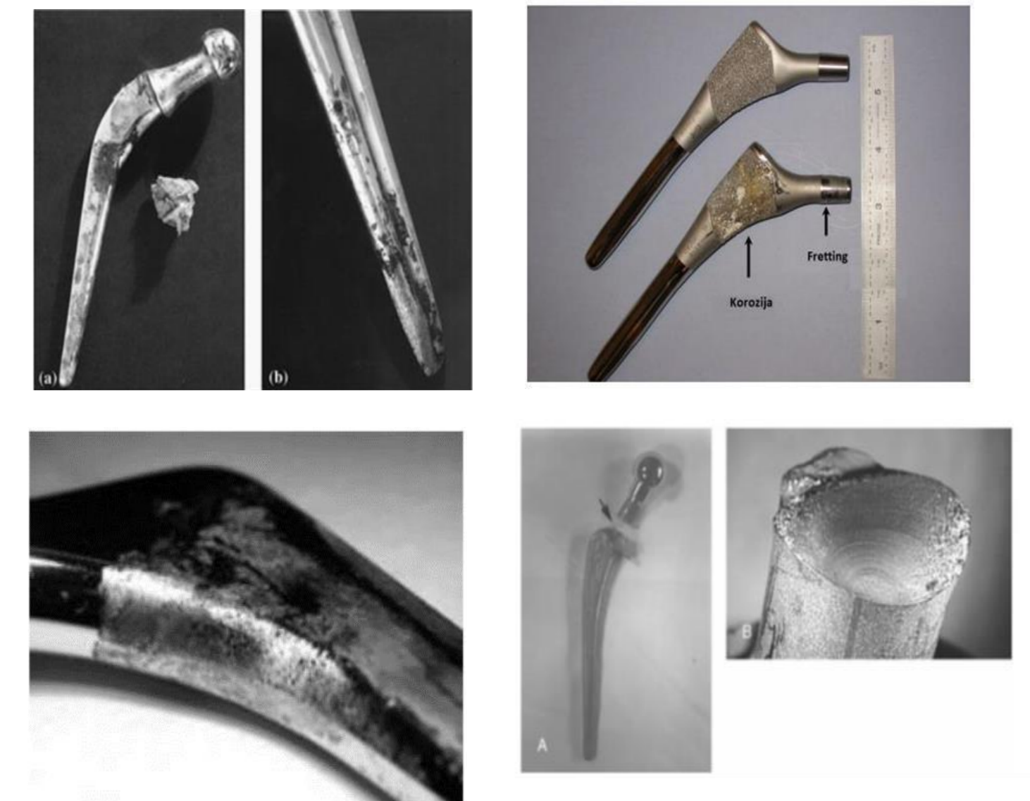
Slika 2: Korozijska oštećenja endoprotetskih implantata zgloba kuka [7,8,9]
